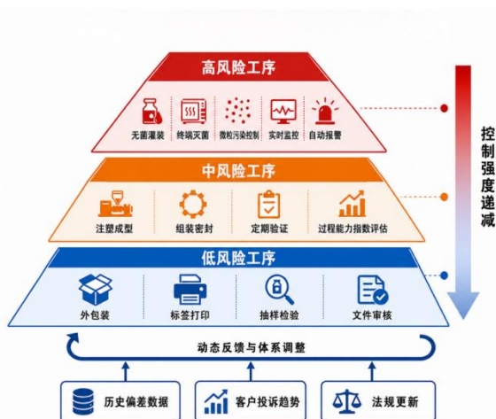
图1 给药器具生产工序风险分级管控体系示意图
