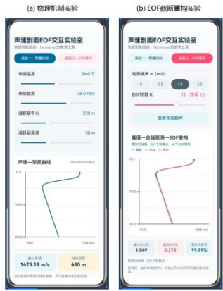
图 2 HarmonyOS 原型应用 SSPEOFLab 在 DevEco Studio 预览器中的交互界面：（a）物理参数调节与声速剖面生成；（b）含噪观测的 EOF 截断重构与单次误差反馈。该图展示代表性单次交互状态，不替代图 1 的重复实验统计结果。
