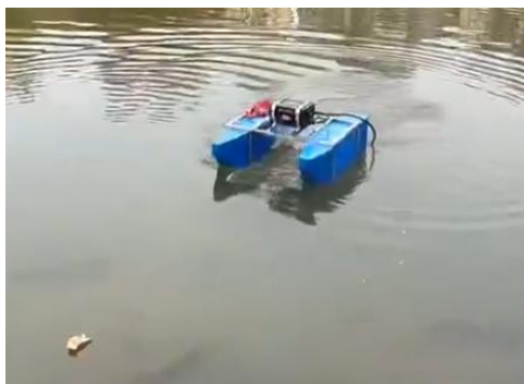
图1 小型双体遥控式水面漂浮物清理装置
