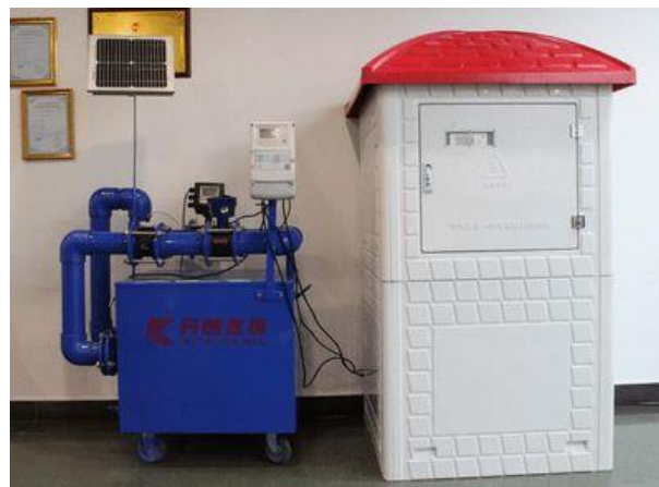
图 1 智能传感技术应用于水泵控制柜的现场部署示意
