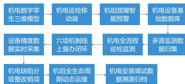
图1 水电站机电设备数字孪生+六项机制全周期质量管理流程
