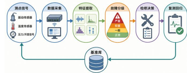
图2 水轮机状态监测与故障诊断链条
