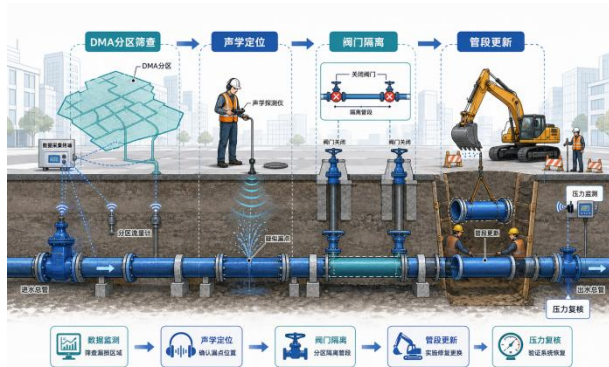
图1 老旧供水管网漏损检测与改造施工控制示意
