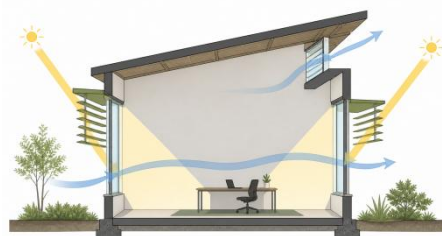
图3 采光通风与遮阳构造协同关系
