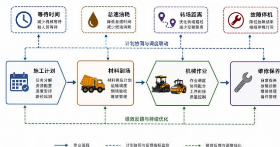
图3 路面机械等待停置调度反馈关系
