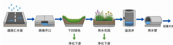
图1 道路海绵排水设施衔接示意
