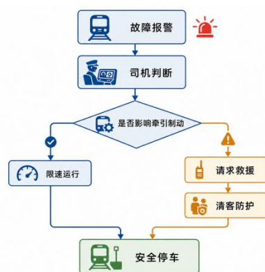
图3 列车设备故障处置影响机制
