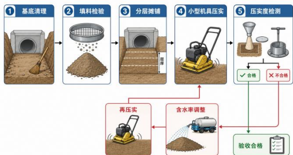
图2 台背回填分层压实检测闭合流程
