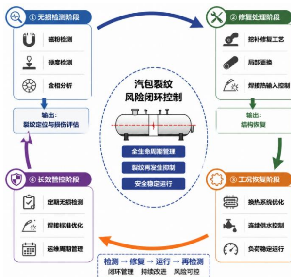
图1 汽包裂纹风险闭环管控流程图
