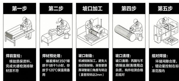
图 1 焊前原材料与坡口预处理管控
