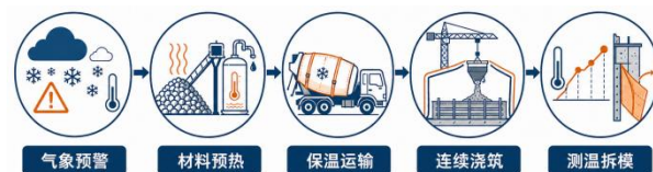
图2 水利工程冬季施工保温控制流程
