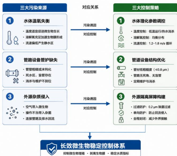
图1 纯水管道微生物污染诱因与管控策略对应体系图
