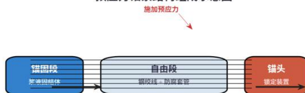
预应力锚索结构组成示意图
