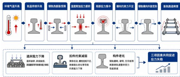
图1 胀轨跑道病害形成演化机理流程
