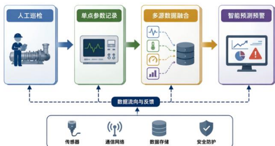
图 1 燃气轮机轴系振动监测技术演进路径与体系架构
