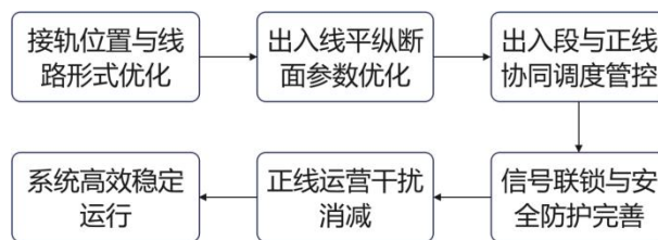
图1 车辆段出入线布置优化缓解正线运营干扰实施流程图
