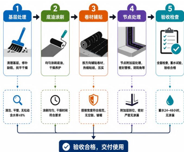
图1 建筑防水施工标准工艺流程
