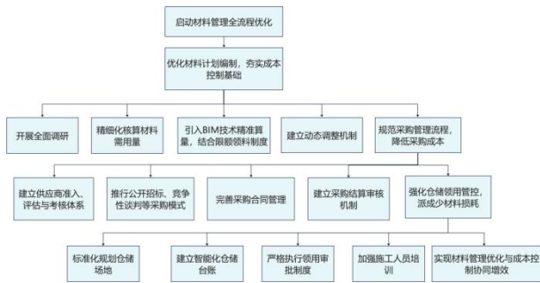
图1 建筑工程项目材料管理全流程优化及成本控制流程图
