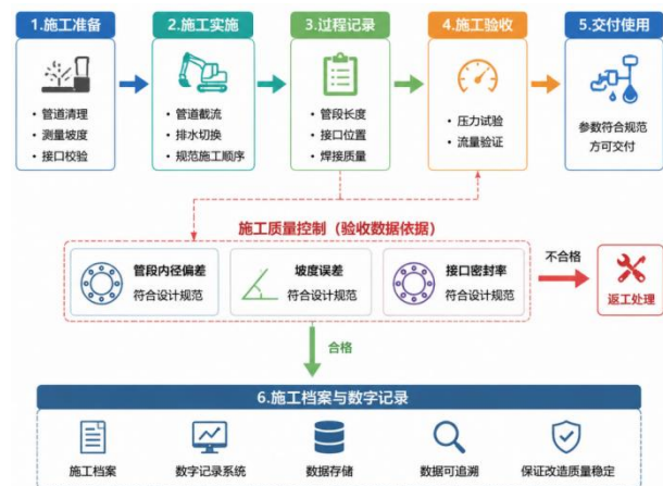
图 1 城市排水管网改造施工流程与质量管控图
