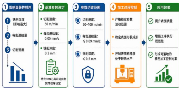
图 1 切削参数优化与表面质量控制实施流程图
