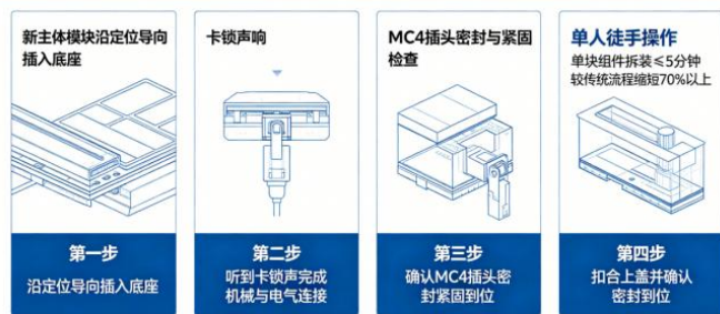
图3 模块化接线盒快速安装图
