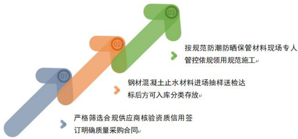
图1 水利基坑支护材料全流程质量管控流程图
