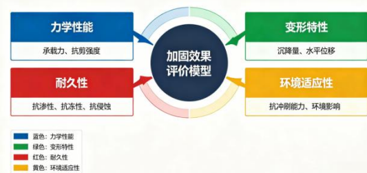
图1 软土地基堤岸加固效果多维度评价模型
