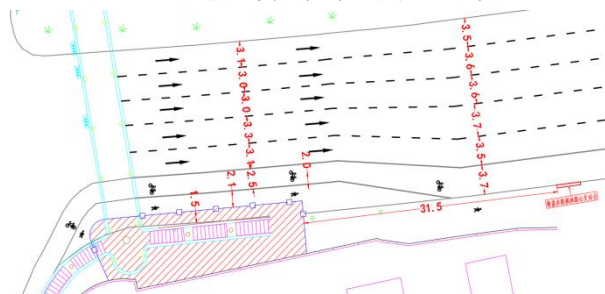
图 2.2-2 天桥北侧围挡布置及交通导改图
