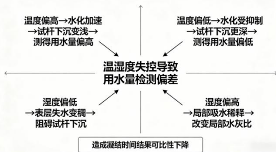
图1 温湿度失控对标准稠度用水量检测的干扰机制示意图
