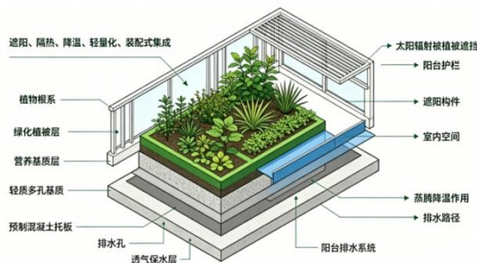
图1 阳台集成化绿化模块结构与功能示意图
