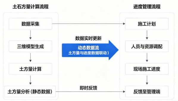
图1 土石方量计算与施工进度管理数据联动流程
