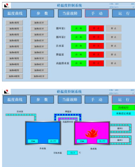
图 18 混凝土冷却测温集成装置
