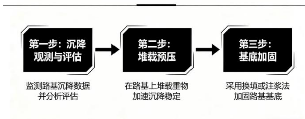
图1 旧路基沉降预处理流程图
