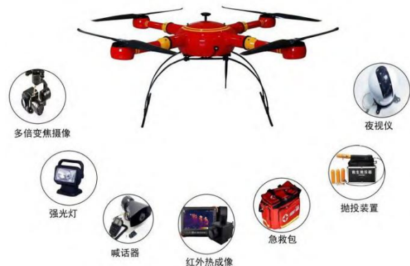
图 1 矿山测量用无人机任务荷载配置示意图
