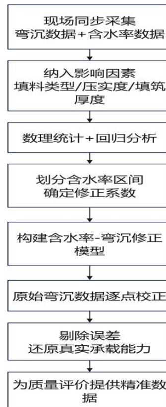
图1 基于含水率的弯沉数据修正模型构建流程图
