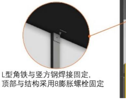
图5 龙骨与顶部结构连接
