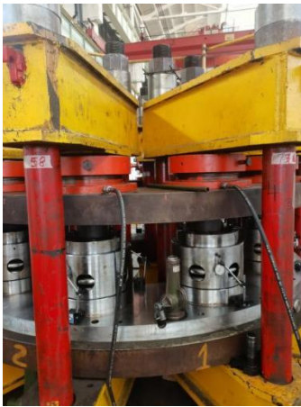
图2 弹性油箱负荷试验
