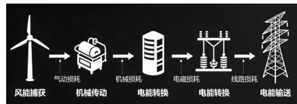
图1 低风速风电能量转化与传输全流程损耗示意图
