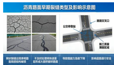
图1 沥青路面早期裂缝类型及影响示意图
