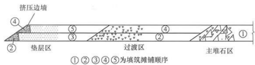
图 2 垫层料、过渡料填筑摊铺顺序
