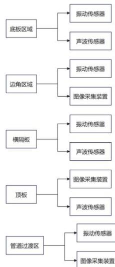
图 2 混凝土构件振捣过程传感节点空间布置示意图
