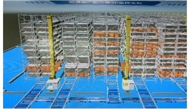
图 2 堆垛机监控服务器界面
