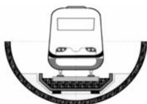
图2 浮置板有砟轨道示意图
