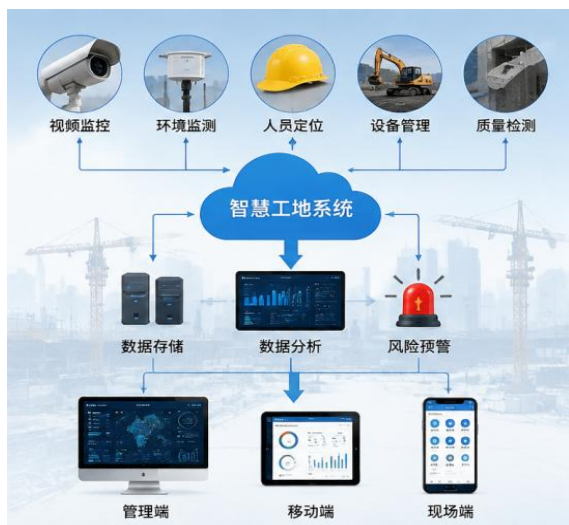
图2 智慧工地系统的技术架构与功能组成
