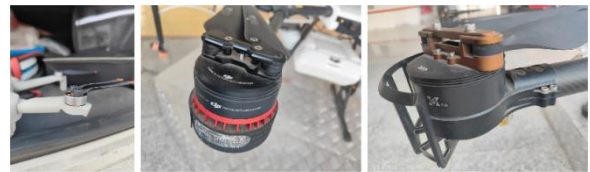
(a)敞开式结构(b)定子固定端布置散热片(c)外转子壁开设风孔
