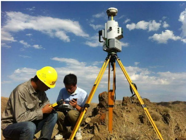
图1 矿区地质测绘现场三维激光扫描数据采集
