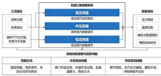
图 1 旁路系统工作原理及控制逻辑
