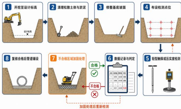
图1 沟槽基底验槽与承载力复核流程图
