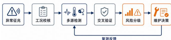
图1 核电厂电气设备状态诊断链
