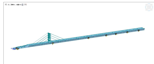
图 7 钢桥顶推典型工况示意图
